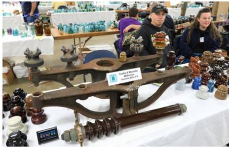
THESE TWO OLD CAST IRON CROSSARMS USED TO HOLD UP POWER CABLES FOR THE PHILADELPHIA TROLLEY SYSTEM BEFORE THEY LANDED ON CURTIS AND MICHELLE WILKINSON'S TABLE.
